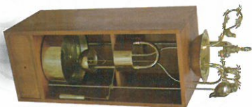
유압자동장치, "지저귀는 새"와 "회전하는 부엉이" (The hydraulic automation of the "crowing birds" and the "turning owl") 필론(Philon) 기원전 3세기 빈백의인 동자극 소리를 발생시키는 자동화 장치
