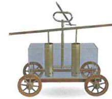
크테시비오스와 헤론의 소방펌프 (The Fire pump of Ktesibios and Heron) 크테시비오스와 헤론(Ktesibios and Heron) 기원전 3세기, 서기 1세기 이중 흡입형 피스톤 소방펌프
