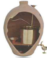
자동 수집기가 있는 자동 성수 판매기 (Automatic holy water server with coin collector) 헤론(Heron), 서기 1세기 고대의 자동 판매기
