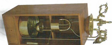
유압자동장치, "지저귀는 새"와 "회전하는 부엉이" (The hydraulic automation of the "chirping birds" and the "turning owl") 필론(Philon) 기원전 3세기 빈백의인 동자극 소리를 발생시키는 자동화 장치
