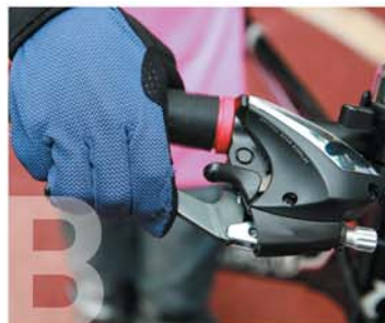
B (Brake) 브레이크 브레이크가 제대로 멈추는지 체크
