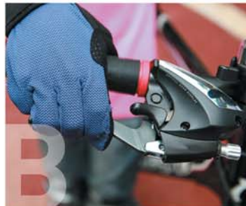
B (Brake) 브레이크 브레이크가 제대로 멈추는지 체크
