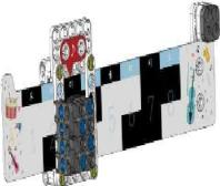
동물 음악대       | <ul style="list-style-type: none"> <li>적외선 센서를 이용한 전자기타 조립하기</li> <li>적외선 센서의 감지 여부에 따라 낮은 도부터 높은 도까지 변수 '위치' 값 지정하기</li> <li>'소리 저장소'에서 소리 불러오기 &amp; 변수 위치 (각 계이름)마다 적절한 소리 적용하기</li> </ul>                                                                                      |
