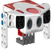
붉은 화성   | <ul style="list-style-type: none"> <li>■ 초음파 센서에 감지된 거리에 따라 스프라이트가<br/>위, 아래로 이동하게 코딩하기</li> <li>■ 가속도 센서를 이용하여 로봇을 좌우로 기울였을 때<br/>스프라이트가 좌우로 이동하게 코딩하기</li> </ul>                       |                                                                                                                                                                                                                                           |
