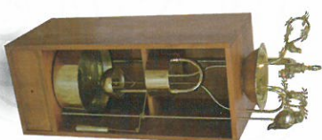
유압자동장치, "지저귀는 새"와 "회전하는 부엉이" (The hydraulic automaton of the "chirping birds" and the "turning owl") 필론 (Philon) 기원전 3세기 빈백의인 동자극 소리를 발생시키는 자동화 장치
